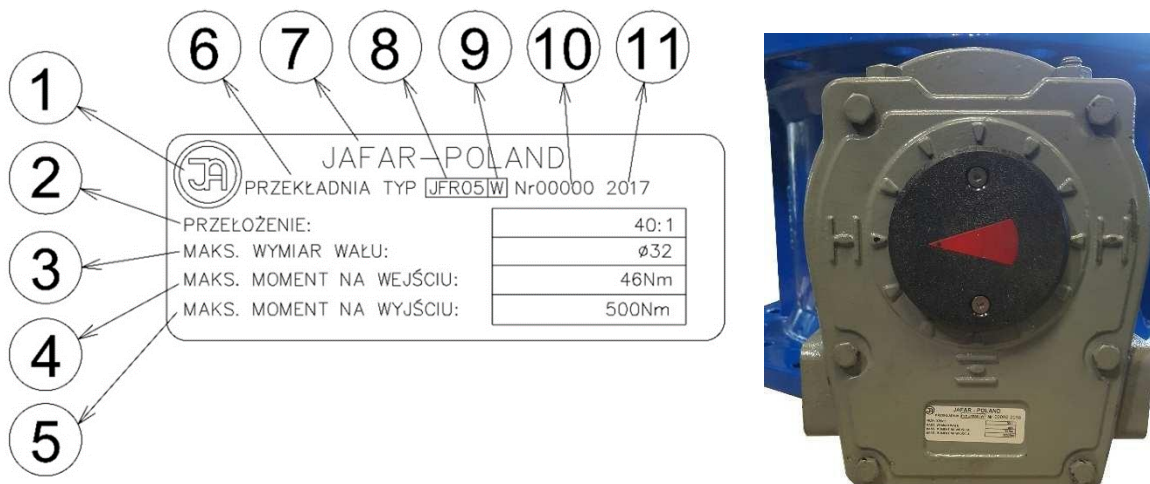
Fig. 2. Etiquette de marquage réducteur de vanne papillon
